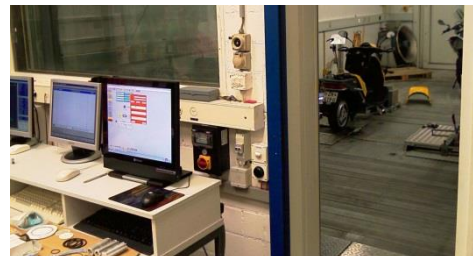
Praktische Überprüfung auf dem Empa Dynamometer. Messverfahren nach Standardprozeduren
